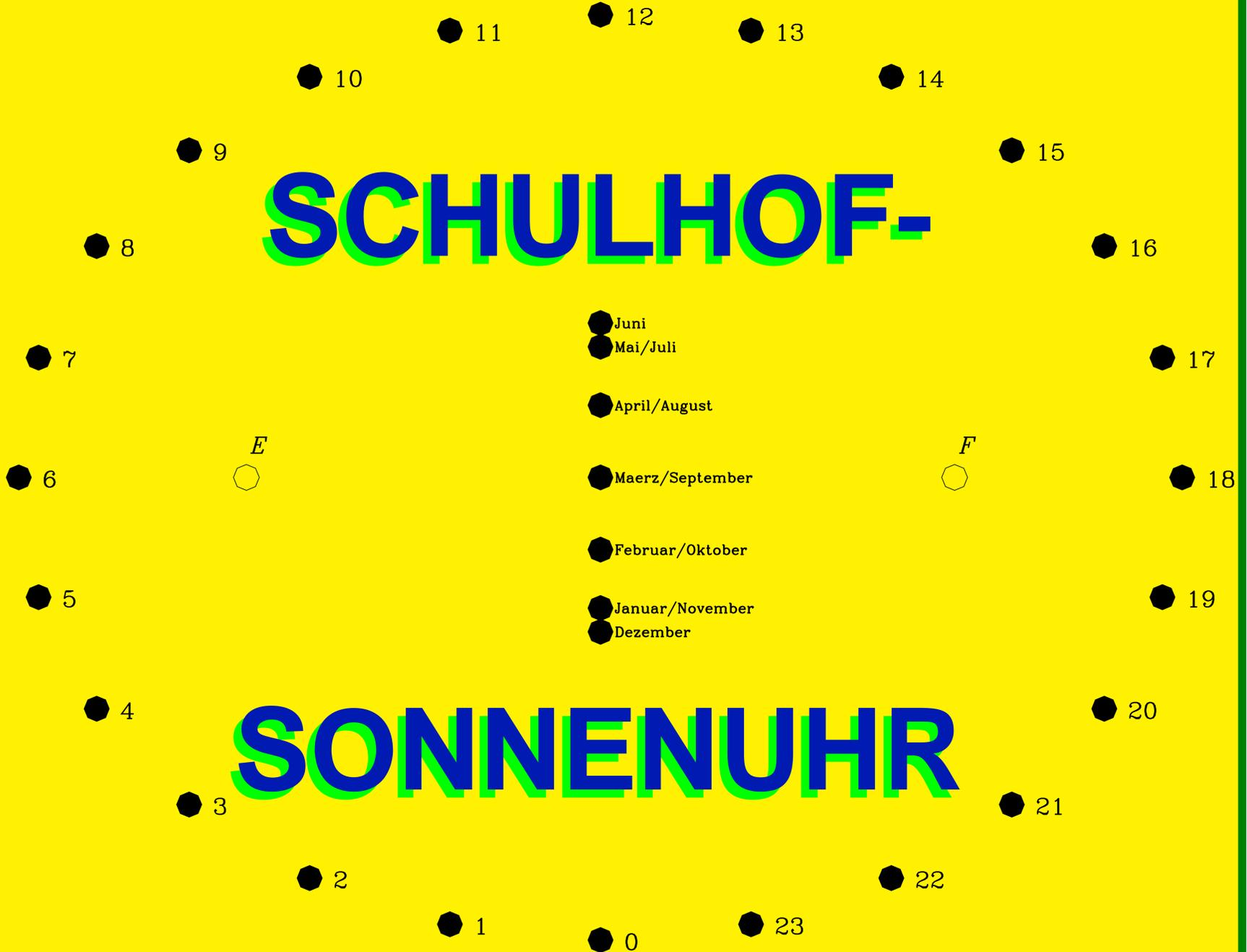
Diese Sonnenuhr ist für einen offenen Hof geeignet. Nichts an ihr kann abbrechen, nichts ist ein Stolperhindernis. Sie wird einfach auf einen ebenen Boden gezeichnet. Die Stundenmarkierungen liegen auf einer Ellipse, die mit der Gärtnerkonstruktion hergestellt werden kann. Nehmen Sie ein Informationsblatt!
